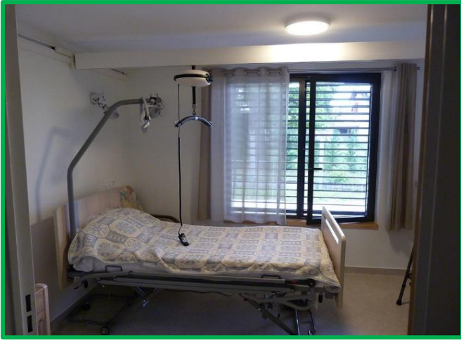
1-Lève-personne sur rail plafonnier en H avec moteur "fixe" débrochable
